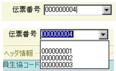
文字入力のための矩形領域(テキストボックス)と項目選択リスト(リストボックス)を組み合わせたもの。テキストボックスに直接文字を入力することができるほか、テキストボックスの右端のボタンを押すと選択可能な項目の一覧が表示され、その中からひとつを選ぶことができる。
